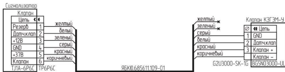
Рисунок В.8 – Схема подключения К3ГЭМ-У с разъемом ВГ5НО3000-UL к сигнализатору с разъемами Т1А-6Р6С.
