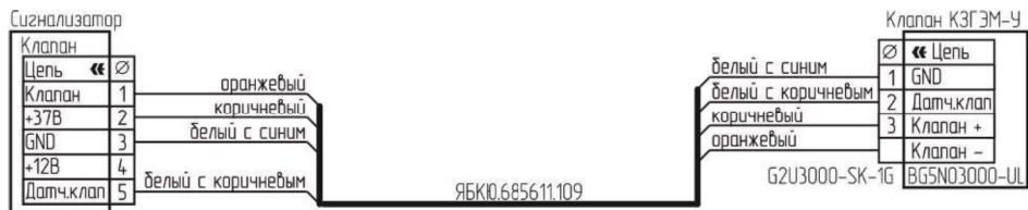
Рисунок В.4 – Схема подключения КЗГЭМ-У с разъемом BG5N03000-UL.
