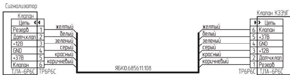
Рисунок В.9 – Схема подключения клапана К3ЭУГ с разъемом Т1А-6Р6С к сигнализатору с разъемами Т1А-6Р6С.
