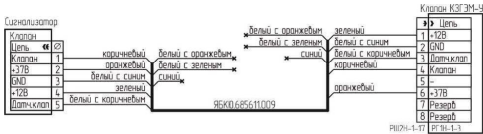
Рисунок В.3 – Схема подключения клапана КЗГЭМ-У с разъемом PG1H-1-3.
