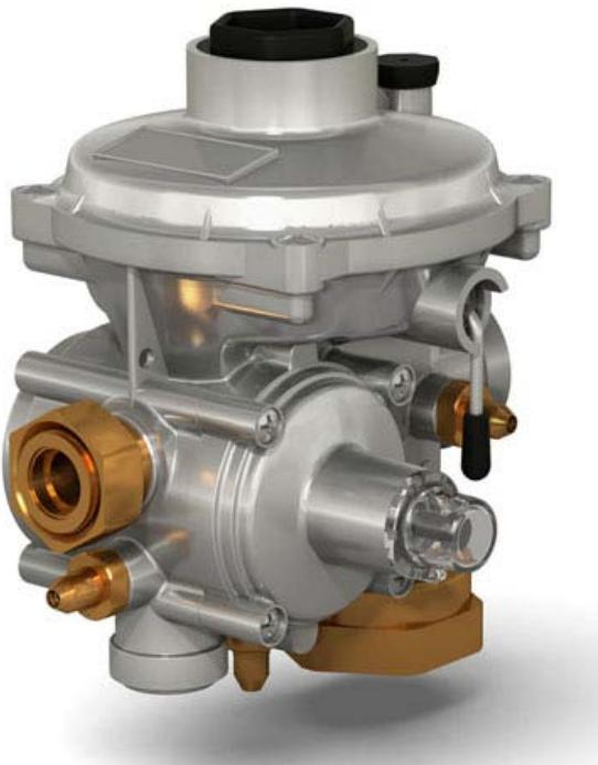
Регулятор давления комбинированный предназначен для поддержания величины (значения) давления углеводородных газов, газовых фаз сжиженных газов, сжатого воздуха и других неагрессивных газов на выходе постоянным в заданных пределах независимо от входного и работающий без использования постороннего источника энергии.
