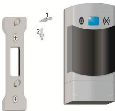
Рисунок 3 – Установка сигнализатора на монтажную панель
